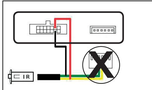
I - Il 4/079 è un sensore ad infrarossi che collegato alle interfacce 4/070-73-83 permette di pilotare l'autoradio tramite i comandi al volante. Il sensore deve essere installato preferibilmente sulle plastiche del piantone dello sterzo con una inclinazione massima, rispetto all'autoradio di 70° e a una distanza massima di 70 cm.
